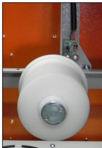
Foto 2: Bobina sem trava de fixação
