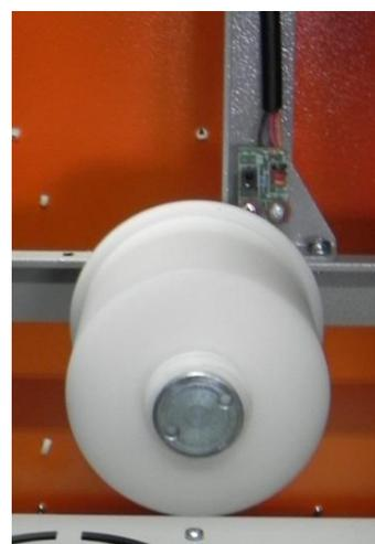
Foto 2: Bobina sem trava de fixação
