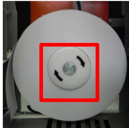
Foto 4: Posição da bobina com trava de segurança
